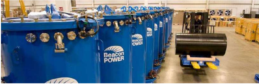
Hình 39: Ảnh bánh đà của Beacon Power [6]. Một bánh đà bằng sợi tổng hợp khác do xe nâng đang vận chuyển phía phải. Mỗi bánh đà có công suất 100 kW. Ảnh chụp tại kho của nhà sản xuất.
