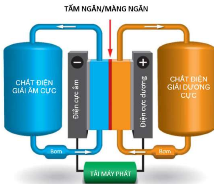
Hình 14: Sơ đồ nguyên lý của pin dòng oxy hóa khử.
