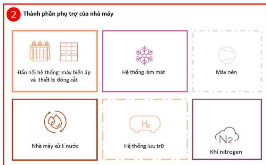
Hình 54: Các thành phần phụ trợ chính của nhà máy sản xuất H 2 . Máy nén và hệ thống lưu trữ được thể hiện bằng đường chấm vì không cần thiết trong mọi nhà máy sản xuất hydrogen.
