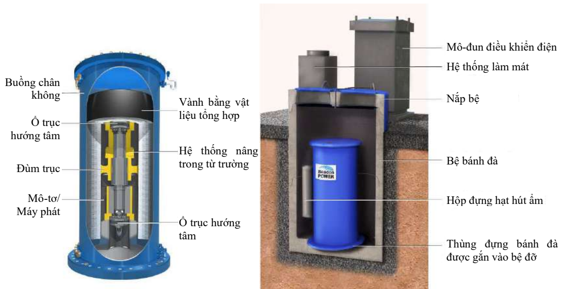
Hình 40: Mặt cắt bánh đà và mô tả cách lắp đặt từng mô-đun trong hệ thống bánh đà Beacon [6]
