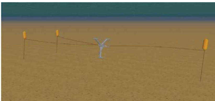
Hình 69: Các loại chân đế: Các thiết bị thể hệ thứ hai - Hệ thống neo sử dụng dây và phao. [7]
